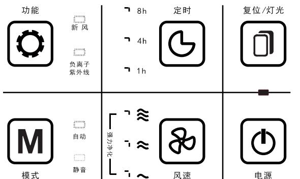
机器在正常工作1600小时后，发出急促连续的警报声，同时显示(电源指示灯)指示灯一直慢速闪烁（待机红灯、工作蓝灯闪），提示更换滤网。
