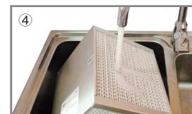
④ 使用淋浴喷头简单冲洗，如有必要可使用中性的液体清洁剂清洗（再用清水冲洗干净）
