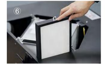
6、更换新风端粗效滤网 将新的粗效滤网按照滤网标签指示方向安装至原位
