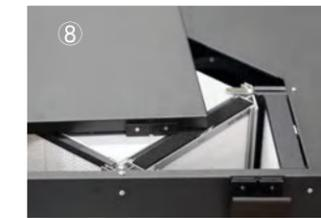
8、最后将检修盖复原，塑料搭扣扣紧
