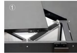
1、打开检修盖塑料搭扣，并平移取下检修盖
