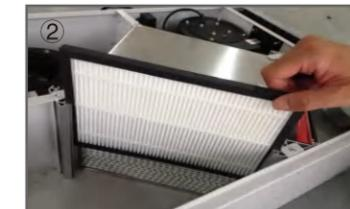
② 将排风端银离子滤网、G2滤网沿导轨垂直向上抽出
