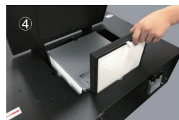
4、将排风端中效滤网沿导轨垂直向上抽出
