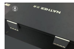
8、最后将检修复原, 塑料搭扣扣紧
